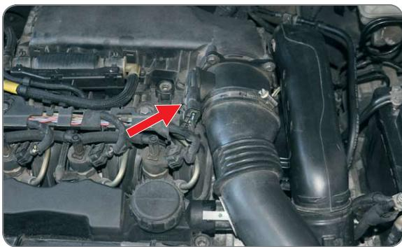
**PL** Zainstaluj obudowę filtra powietrza, podłącz przepływomierz.
