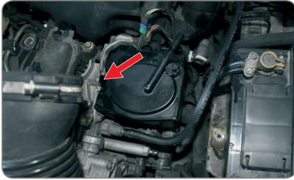
**PL** Wciśnij trzpień zabezpieczający filtr, wymontuj filtr \*
