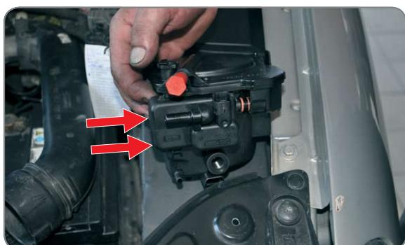
**PL** Zamontuj element podgrzewacza paliwa w nowym filtrze
