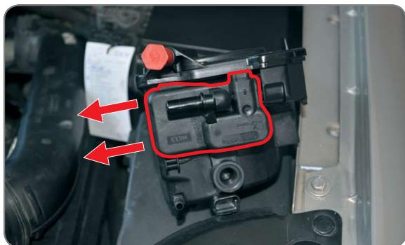
**PL** Ze zużytego filtra zdementuj element podgrzewacza paliwa w kierunku zaznaczonym na rysunku
