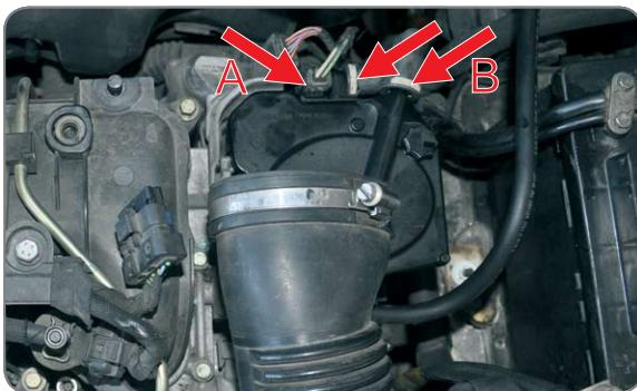
**PL** Wymontuj złącze elektryczne podgrzewacza paliwa (A), odłącz szybkozłączki przewodów filtra paliwa (B)
