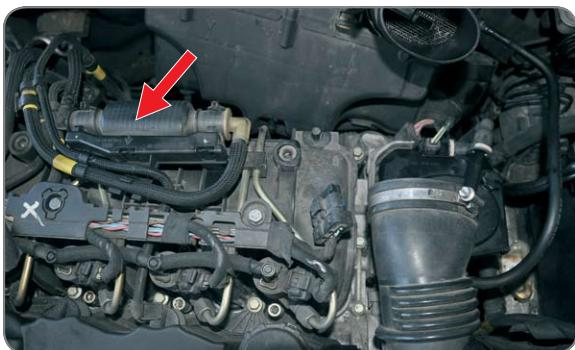
**PL** Pompuj paliwo pompką ręczną, aż do wyczucia oporu
